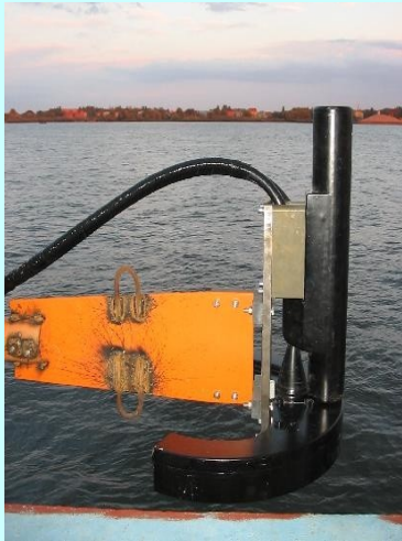
Приёмопередающая антенна эхолота SeaBat 8111.
