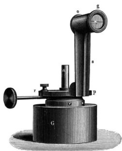
Рис. 4.13: Лампа Хефнера — эталон «свечи Хефнера», единицы силы света, предшествующей канделе.
