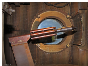
Рис. 6.19: Испытания модели ракетносителя «Ангара» в АДТ Т-117. [©цаги]
