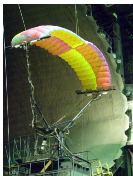
Рис. 6.26: Испытания планирующего парашюта в АДТ Т-101. [©цаги]
