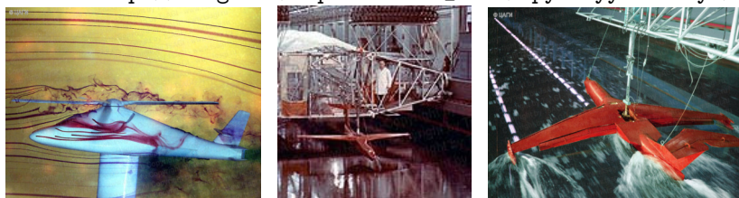
Рис. 6.34: Исследование обтекания модели вертолета в гидродинамической трубе и испытания модели самолёта-амфибии А-40 в гидроканале ЦАГИ. [©ЦАГИ]
