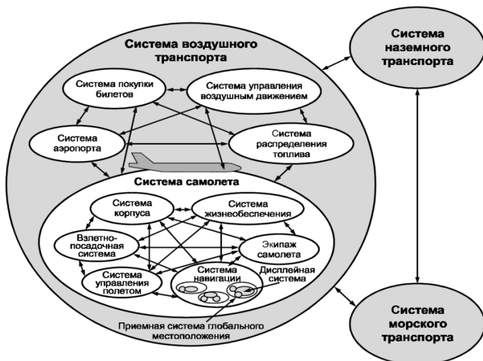
Рис. 4. Многоуровневые системы. Стандартное представление системы самолета в среде его использования (ГОСТ Р ИСО/МЭК 15288—2005)
